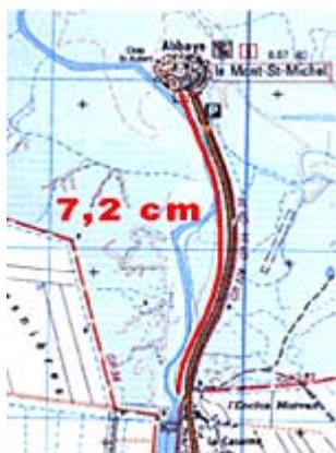
Pour les distances non rectilignes, sur une route ou sur un sentier sinueux, on peut utiliser un curvimètre (instrument servant à mesurer la longueur des lignes courbes).
